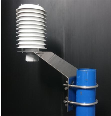
KNVS-09 , KNVS-14 型自然通風シェルターは、温度計、湿度計センサが収納可能で、雨や直射日光の影響からセンサを守ります。自然通風式のため、自然風にて通風を行い、通風ファンは搭載していないので、電源は不要です。
